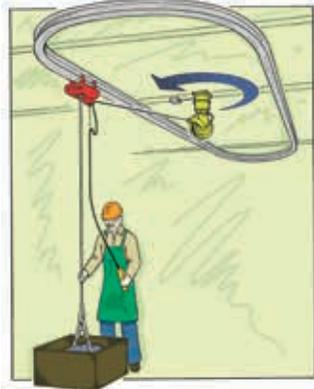
Las Bases de Rotación Completa permiten que los enrolladores giren 360 grados en aplicaciones en las que se requiere una rotación eléctrica continua. Cuentan con rodamientos de bola que giran completamente libres dentro de una estructura estanca al agua y al polvo. Tienen agujeros de acceso para una inspección simple del anillo colector. Versión para zonas inflamables y/o volátiles disponible - ver pág. 19.
