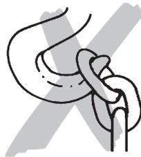
No gire la carga, pues ni el cable y ni el gancho de la carga del aparato están concebidos para el giro de la carga suspendida. Si se tuviese que realizar un giro, según el uso previsto, tendrían que utilizarse dispositivos antitorceduras o debería consultarse con el fabricante. Los cables no se pueden torcer.
